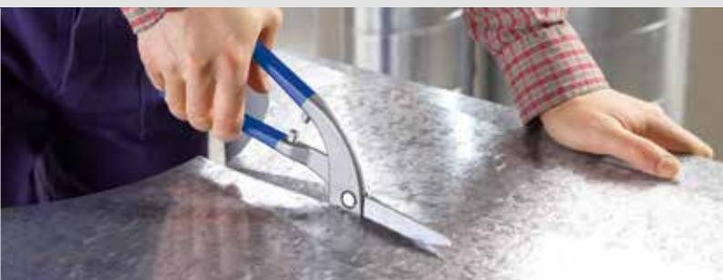
Обычные ножницы для резки листового металла
