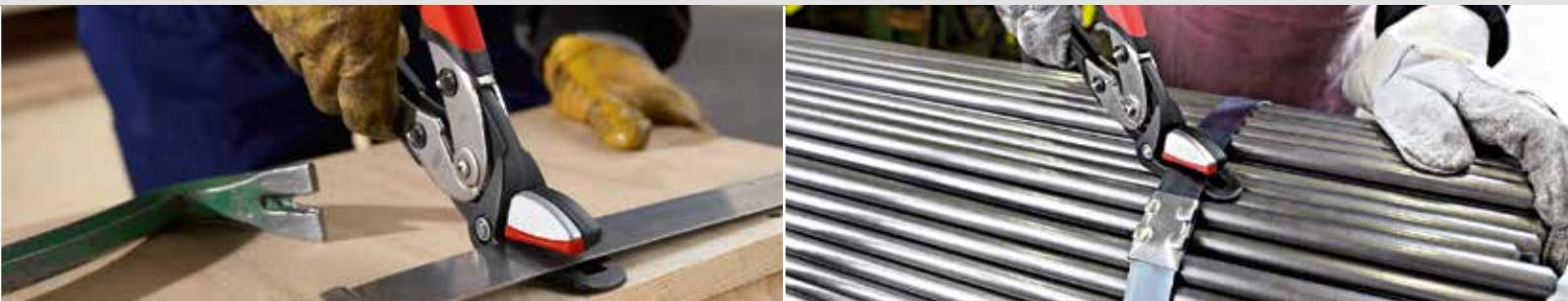
Ножницы для ленточной стали с рычажной передачей
