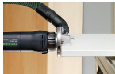
Скругление пластмассовой или деревянной кромки.
