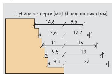
\*\* Комплект поставки: комплект опорных подшипников от Ø 9,5 мм до Ø 22 мм
