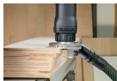
Фрезерование пластмассовой или деревянной кромки.
