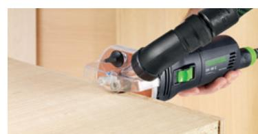
Фрезерование пластмассовой или деревянной кромки заподлицо.
